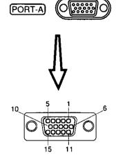
Pin assignments of 15 pin mini D-Sub connector
